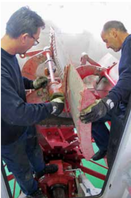
Schauflerrad, Revision der Lagerbüchsen. Foto 21.3.2017
